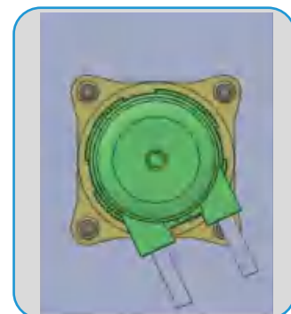
将泵头上盖装入泵壳相应孔内
