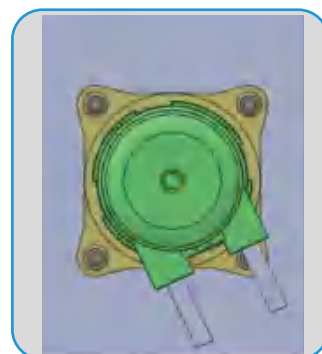
将泵头上盖装入泵壳相应孔内
